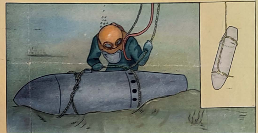
Остропка магнитной сигарообразной мины пеньковым тросом-удавкой с наброской одного шлага.
