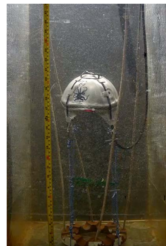
Рис. 5. Подводное убежище мягкой конструкции «Черная каракатица»
