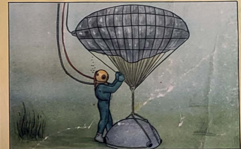
Остропка магнитной сигарообразной мины пеньковым тросом-удавкой с наброской одного шлага.
