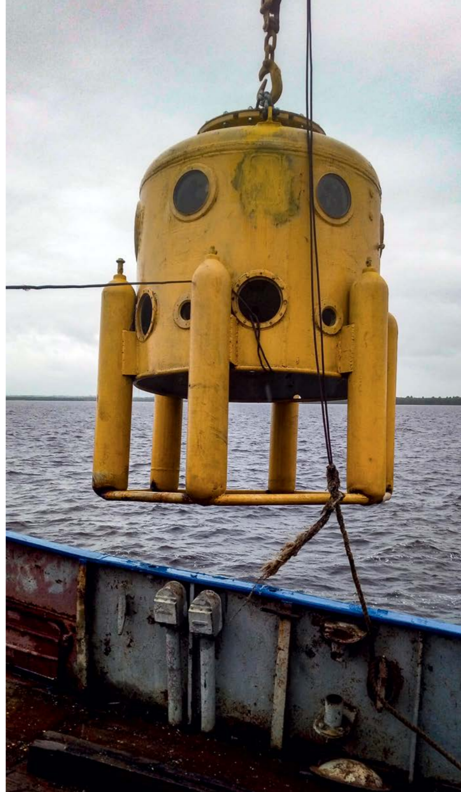
Рис. 6. Подводное убежище жесткой конструкции Кухтарова
