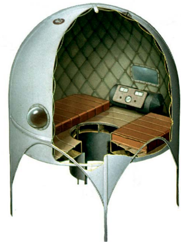
Рис. 4. Конструкция подводного дома-убежища «Спрут»
