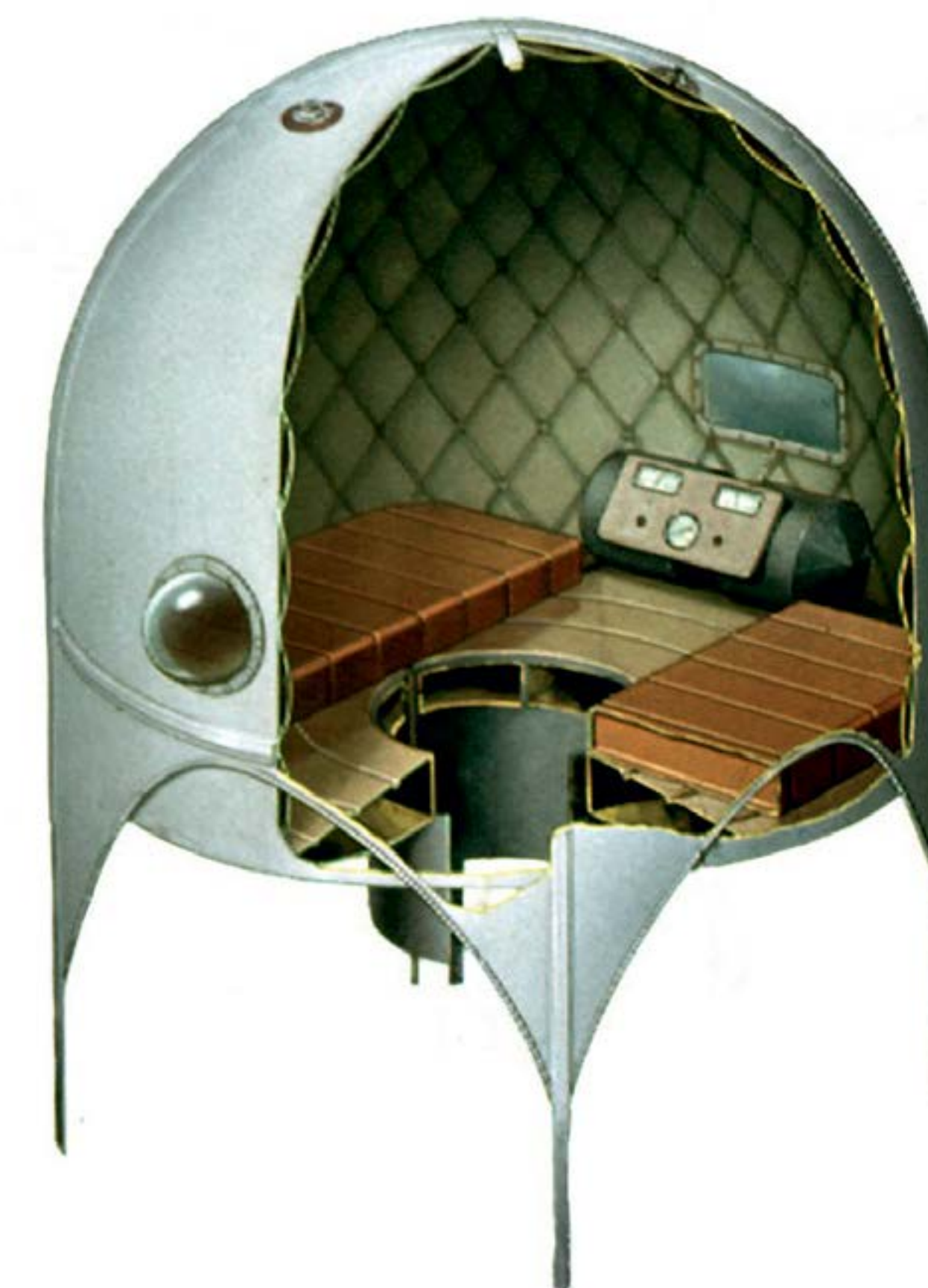
Рис. 4. Конструкция подводного дома-убежища «Спрут»
