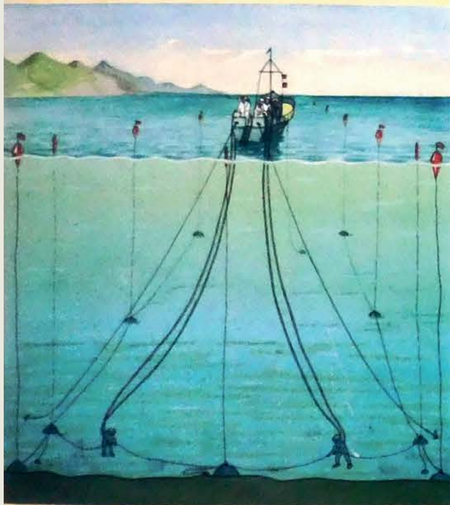
ДВИЖЕНИЕ ВОДОЛАЗОВ ПО ДНУ ВДОЛЬ ХОДОВОГО ТРОСА
