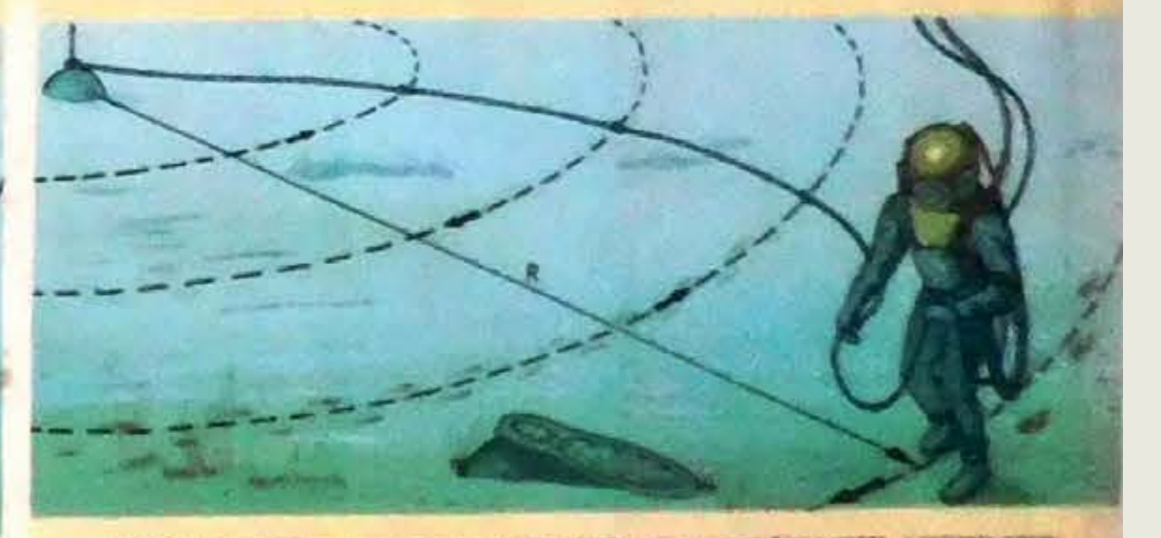
ОБСЛЕДОВАНИЕ ДНА ПРИ ДВИЖЕНИИ ПО КОНЦЕНТРИЧЕСКИМ КРУГАМ
