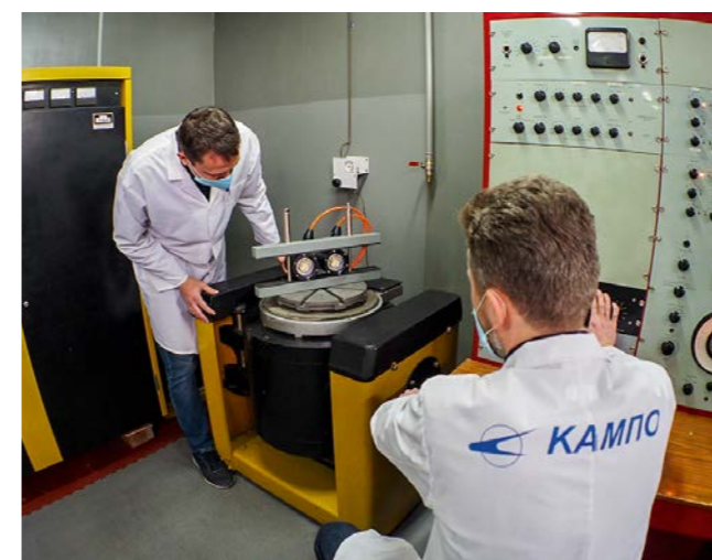
▲ Проверка вибропрочности прожектора подводного ПП-7 на испытательном вибрационном стенде
