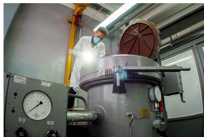
Подготовка светильника подводного кабельного СПК-7 к проверке работоспособности под избыточным давлением ►
