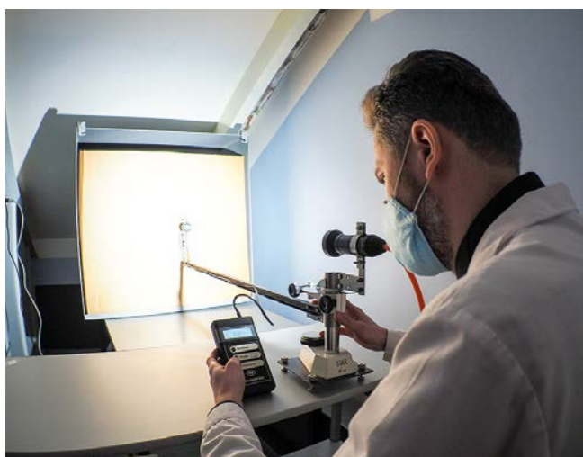
▲ Проверка силы света и угла рассеяния светильника подводного кабельного СПК-7
