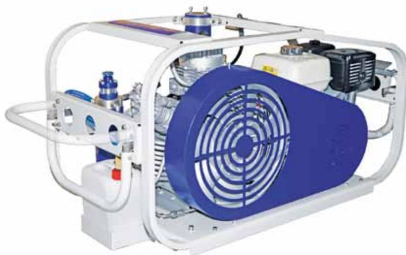
Компрессорная установка высокого давления ПТС «Вектор»-450Б
