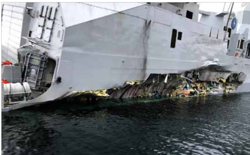
Надводная часть пробоины, ставшей причиной гибели фрегата «Хельге Ингстад»
