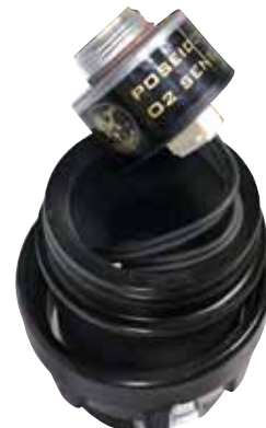
Установка твердотельного датчика в CPDOD
