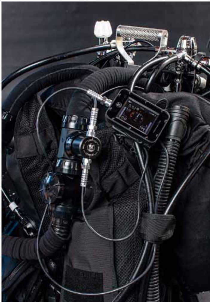
СРОD – устройство для установки твердотельного датчика в контур в качестве резервной системы
