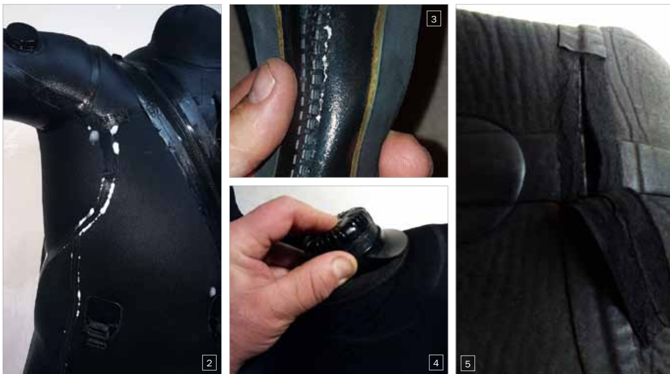
Фото 2. Пропускание воздуха при тестировании швов на новом костюме. Фото 3. Разрушение гидромолнии. Фото 4. Отслоения площадки клапана. Новый костюм. Фото 5. Дефект шва на новом костюме
