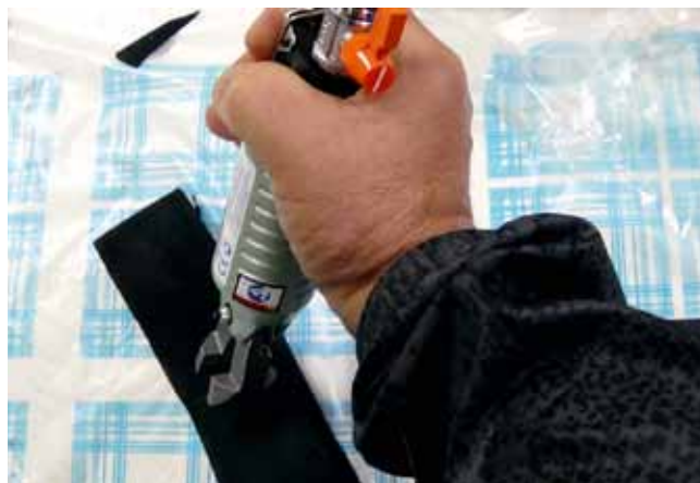
Фото 1. Ниппер — пневматическая машина обжатия шва
