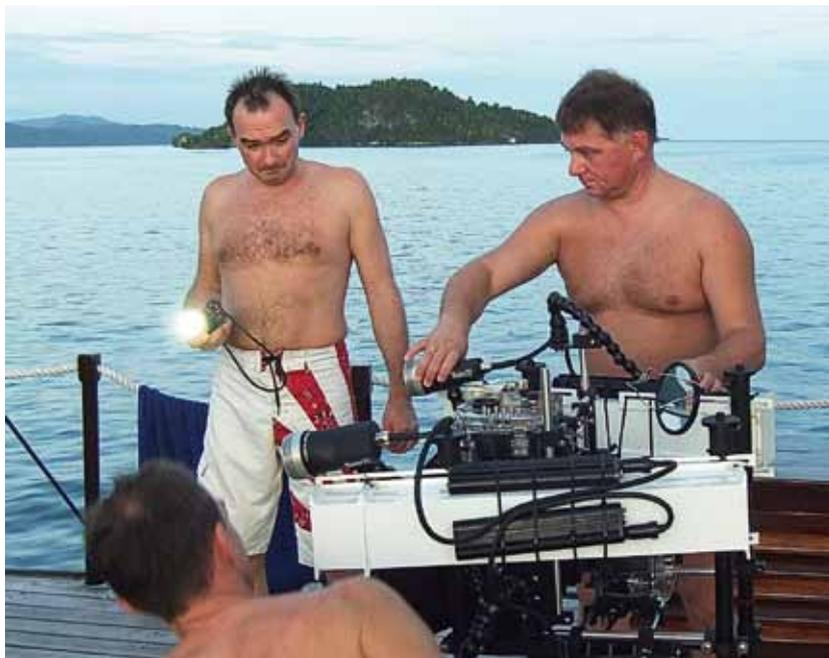
другой техникой — ригом. Риг — это профессиональное оборудование, где две камеры снимают объект под разными углами сквозь полупрозрачное зеркало. Одна камера снимает на просвет сквозь это зеркало, а другая — отражение. Риг позволяет менять параллакс, расстояние между осями и угол наклона камер.
