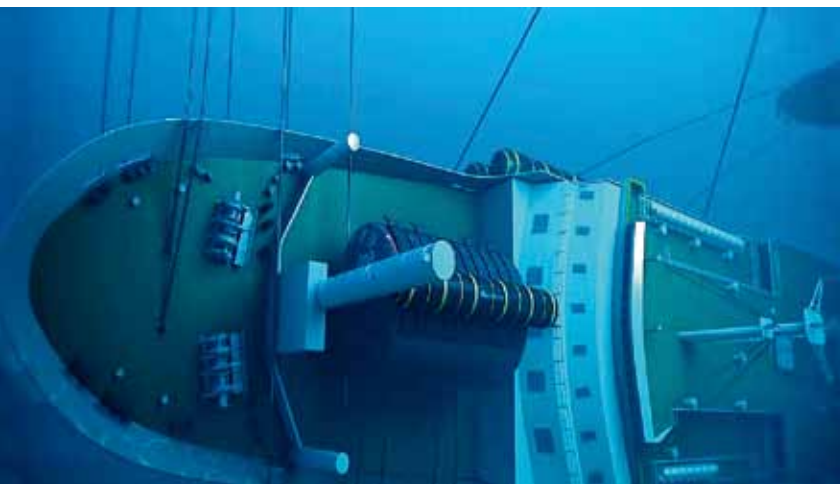
Расположение судоподъемных понтонов
