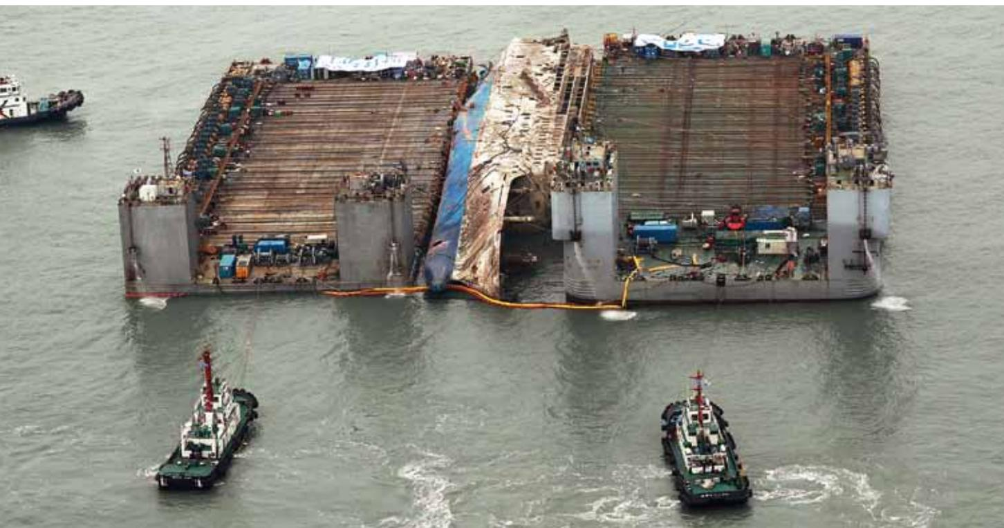
Транспортировка поднятого двумя баржами-площадками парома «Севоль» к месту погрузки на ТПС «Уайт Марлин»
