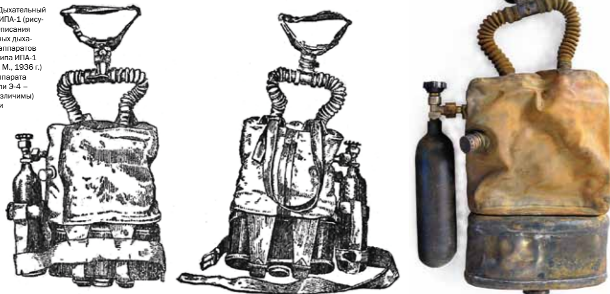
Рис. 03. Схема компоновки и дыхательного цикла спасательного цикла спасательного аппарата Э-4
