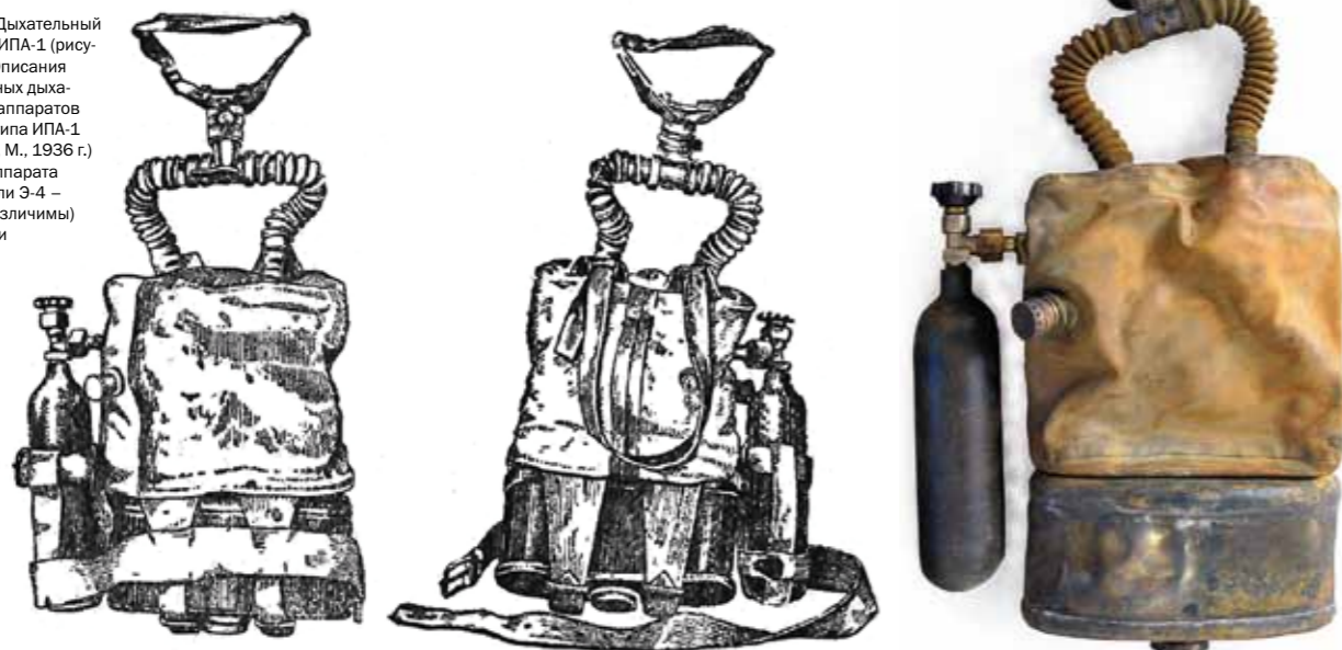
Рис. 03. Схема компоновки и дыхательного цикла спасательного аппарата Э-4
