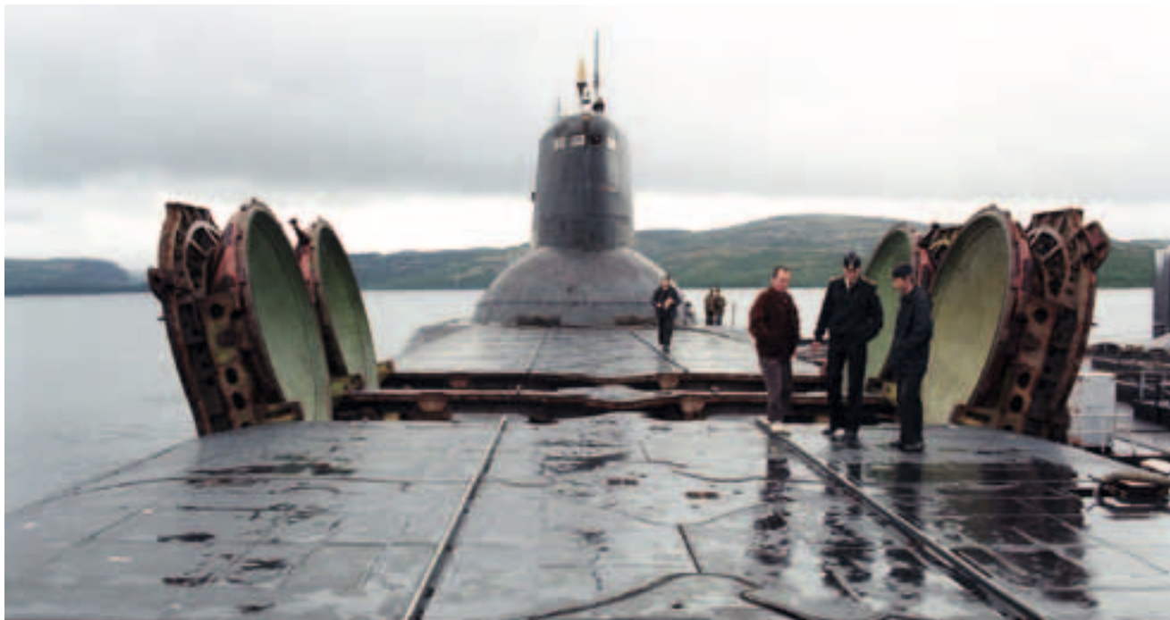
Российская ПЛ проекта 941 «Акула». Водоизмещение подводное: 48000 т, надводное: 23200 т, длина: 172,8 м. Рабочая глубина погружения: 400 м. Силовая установка: 2 ядерных реактора по 190 МВт каждый. Скорость: надводная 12 узлов, подводная 25 узлов. Экипаж: 160 человек
