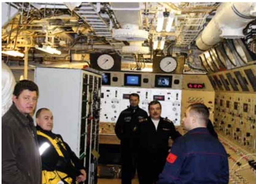
Пост управления барокамерами ГВК-450 сс «Игорь Белоусов». Подготовка акванавтов к вводу в режим ДП
