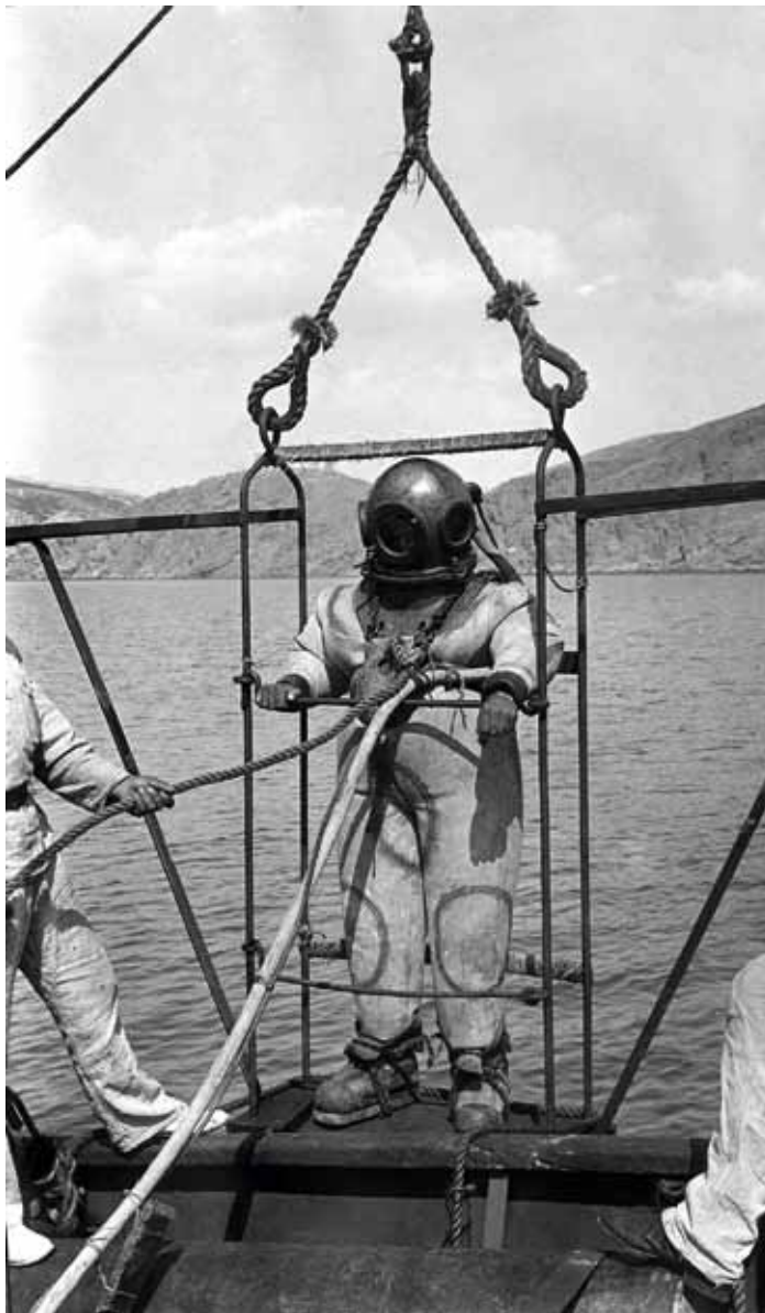
В такой водолазной беседке водолазы ЭПРОНа во время экспериментальных спусков 1935–1936 гг. ходили на глубины более 100 м
