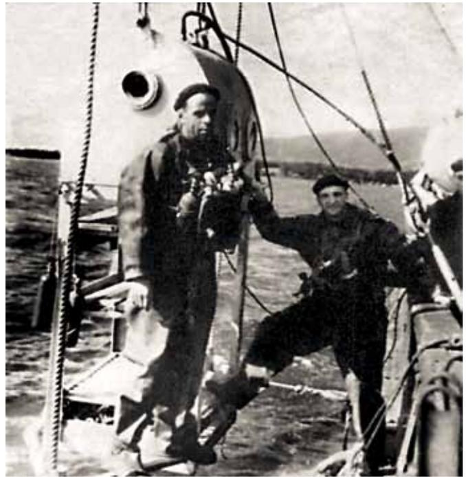
Выход водолазов-испытателей из водолазного колокола открытого типа «Фазтон» после 200-метрового спуска на гелиокислородной дыхательной смеси. Фото 1946 г.
