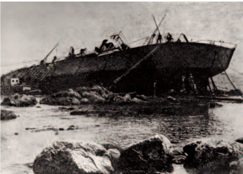
Работы по спасению судна «Лейтенант Краскин» (закрепление судна после поворота с 85 до 45 градусов)
