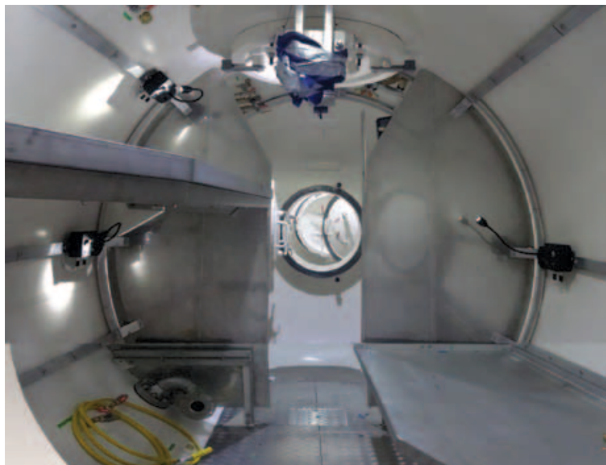
Рис. 4. Интерьер жилого отсека барокамеры в процессе монтажа на заводе-изготовителя
